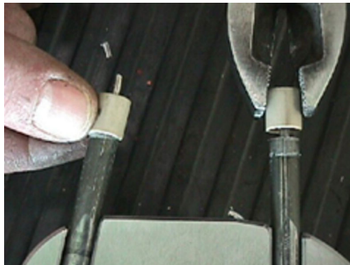
Figura 6-129: Extracción e instalación del casquillo de PEEK
