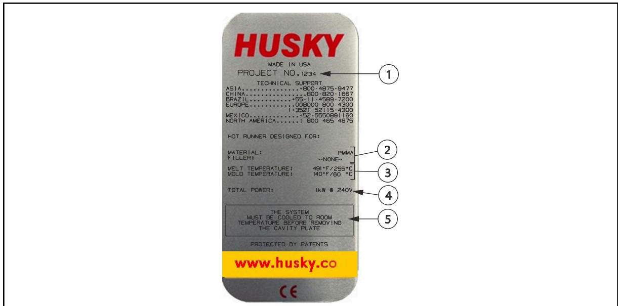
Figura 1-1: Placa de características del canal caliente (ejemplo)
