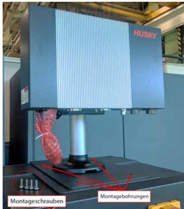
Abbildung 15-32 Bedienoberfläche mit alternativer Befestigung – Bohrungen
