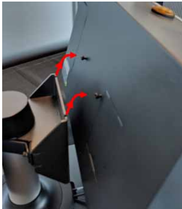
Abbildung 15-20 Entfernen der MCU von der Halterung
