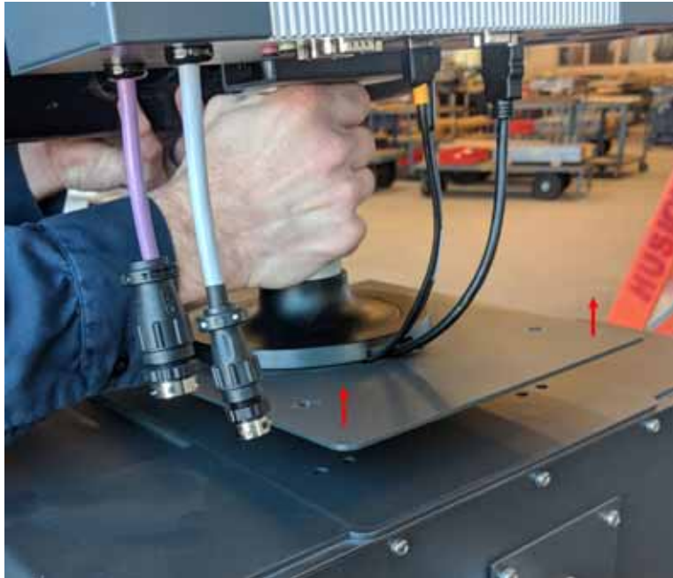
Abbildung 15-23 Entfernen der Bedienoberfläche
