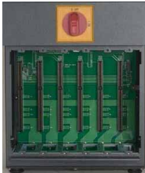
背板裸露的主机托架
